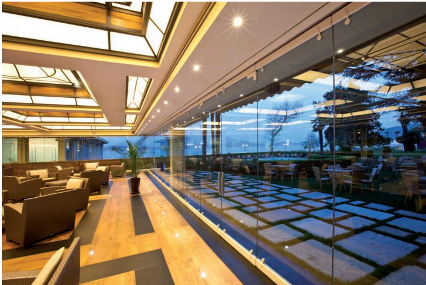
Ogni elemento è costituito da un pannello vetrato portante spessore 12 mm e da due sottili profili in alluminio situati superiormente ed inferiormente atti a contenere i meccanismi di scorrimento e di bloccaggio a pavimento. Ogni elemento viene bloccato in posizione da un semplice meccanismo a scatto, situato in prossimità della traversa inferiore, azionabile mediante apposita maniglia removibile.
