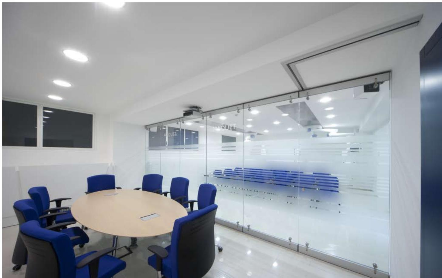
Le pareti manovrabili in cristallo EXTESA rappresentano una elegante possibilità per dividere gli spazi con trasparenza, rispettando i criteri architettonici ed ambientali in cui vengono inserite. In aggiunta agli elementi standard, è inoltre possibile l'inserimento di porte di passaggio a singola o doppia anta in qualsiasi punto della parete. Non sono previste fasce fisse di regolazione a muro. Per questa ragione è necessaria perfetta verticalità in prossimità dei 2 lati estremi della parete.
