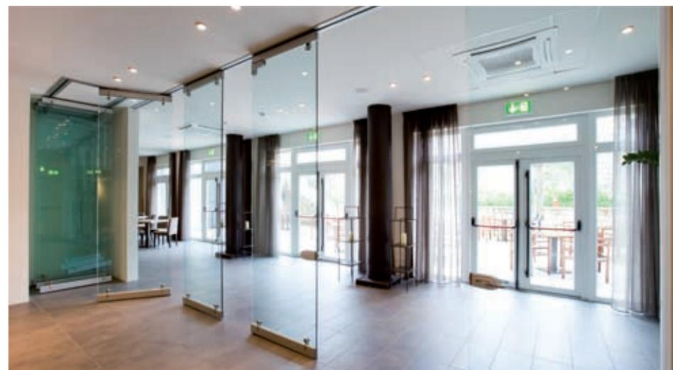
EXTESA è composta da elementi modulari indipendenti che scorrono su una guida in estruso di alluminio fissata a soffitto, senza necessità di guida a pavimento. Lo scorrimento è garantito da due carrelli a bassissimo attrito.
